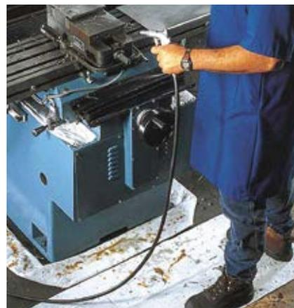
オイル・有機溶剤に加え、水も吸収するので水と混濁したオイルや水溶性オイルの吸収に効果を発揮します。
