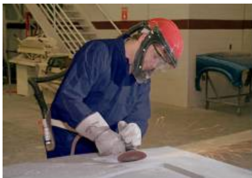
图 1. 松配合呼吸器头罩配防护眼镜
