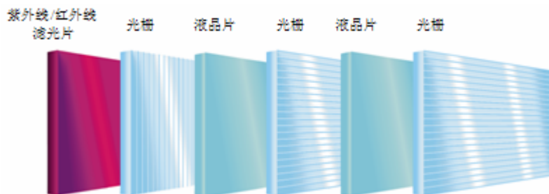
(图 5，自动变光镜片中的光栅/液晶复合镜片)
