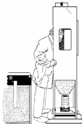
图 2 细菌过滤效率检测方法
