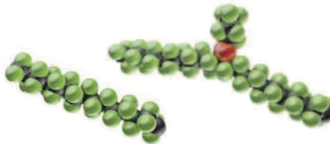
Der molekulare Aufbau von PTFE (links) und modifiziertem PTFE (rechts): Perfluorpropylvinylether (PPVE) wird in die PTFE-Polymerkette eingebaut, diese wird gleichzeitig im Molekulargewicht reduziert
