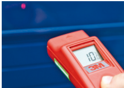
02 Untergrund-Temperatur messen 3M™ Diamond Grade™ 983: 10°–38°C 3M™ Diamond Grade™ 997: 10°–30°C
