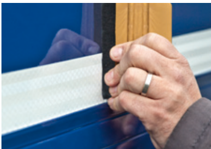
07 Folie mit einer Rakel oder einem Handroller stark andrücken und anschließend bei 3M™ Diamond Grade™ 997 für Planen das Übertragungs-Klebeband entfernen
