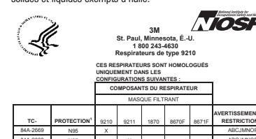
Filtre N95 contre les particules (niveau d'efficacité du filtre de 95%) efficace contre les aérosols contenant des particules exempts d'huile. Des restrictions de durée d'utilisation peuvent s'appliquer.
