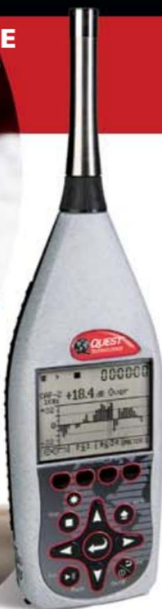
Todos los sonómetros de la serie SOUNDPRO SE/DL incorporan dos canales de medida independientes y simultáneos (A y C) acorde al múltiples regulaciones y normas. Los sonómetros pueden equiparse con filtros de análisis en frecuencias en Tiempo Real 1/1 o 1/3 de octava uno de los canales y manteniendo el otro como sonómetro integrador.
