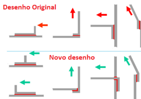
Figura 2. Alguns exemplos de novos desenhos de juntas para máxima resistência adesiva, favorecendo esforços de tensão e cisalhamento.
