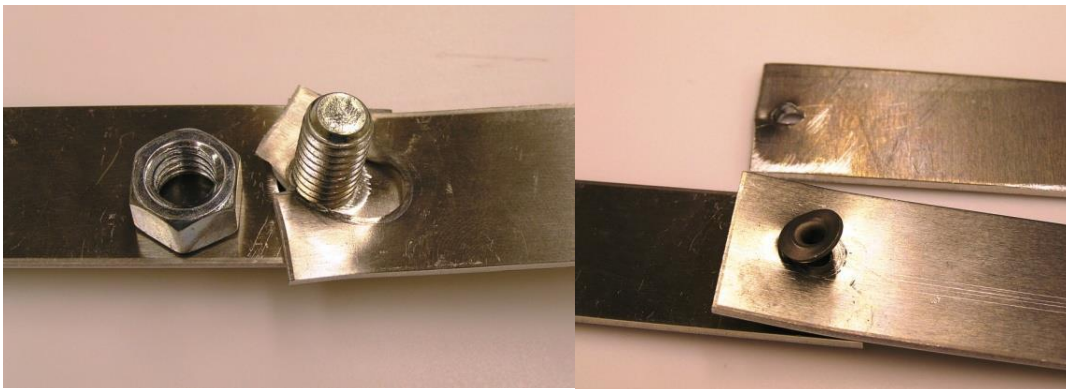
Figura 6. Teste de cisalhamento: falha do alumínio T6061 (0,16 cm de espessura) com rebites e parafusos
