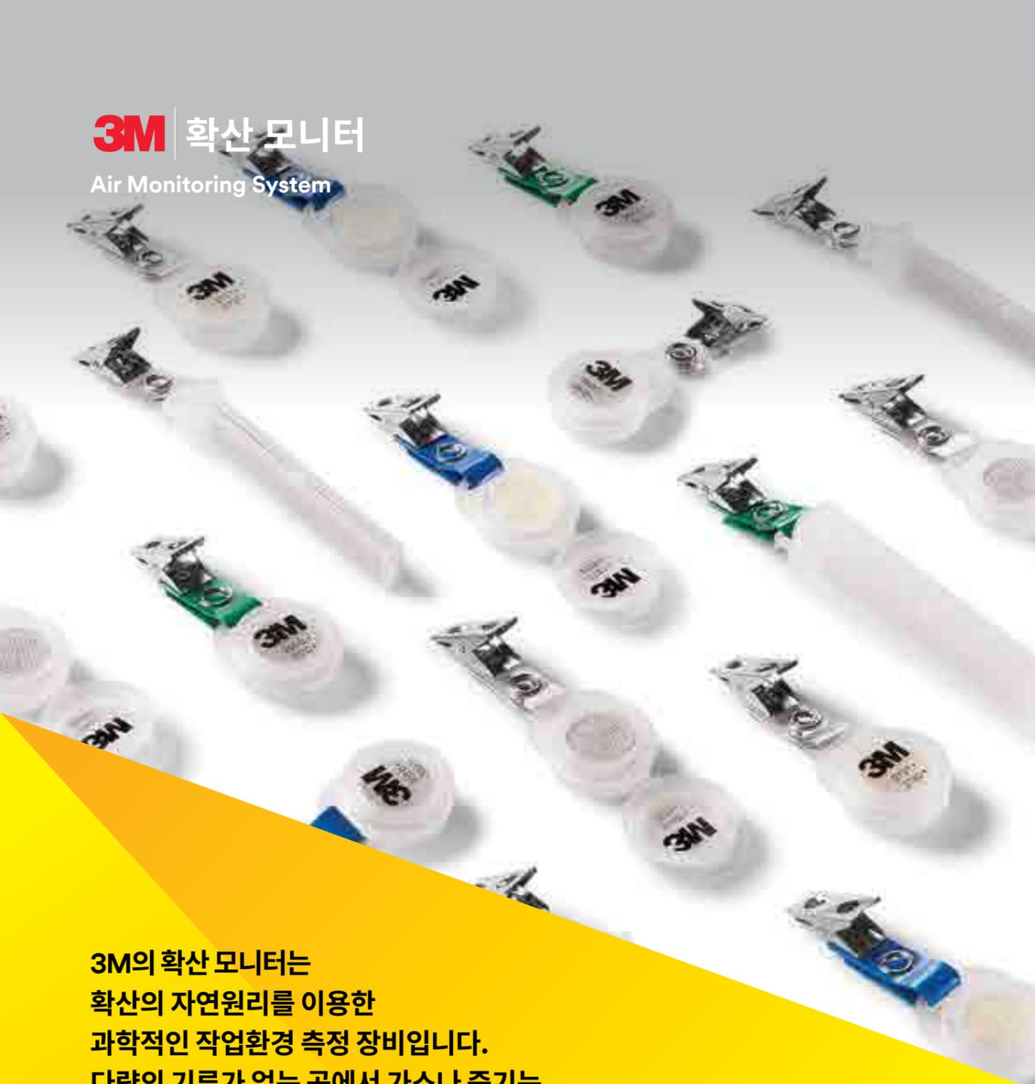
**3M의 확산 모니터는 확산의 자연원리를 이용한 과학적인 작업환경 측정 장비입니다. 다량의 기류가 없는 곳에서 가스나 증기는 고농도에서 저농도로 확산에 의해 이동합니다. 이 때 화학물질의 확산계수, 흡착 표면의 단면적과 길이가 능동 포집법의 펌프의 역할을 하게 됩니다.**
