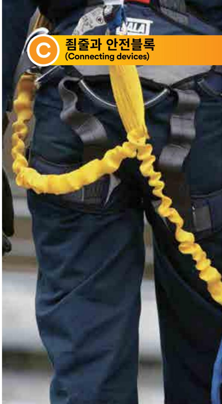
충격 흡수 짐줄(Lanyard) 또는 안전블록 (SRL : Self-Retracting Lifeline)과 같은 장비는 작업자가 착용하고 있는 안전그네와 앵커리지 포인트 사이를 견고하게 연결해주며 충격 흡수, 작업반경 제한, 추락거리 제한 등의 역할을 수행합니다.
