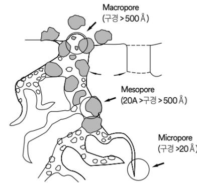
※대부분의 가스/증기는 5~20 Å 사이의 미세 세공 (micropore)에 흡착되며 Mesopore와 Macropore는 수질정화 등 액체처리에 효과가 있습니다.
