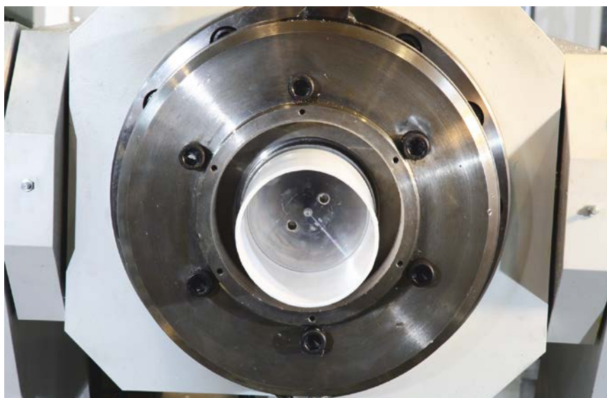
Bild 1. Extruderkopf zur Herstellung eines pastenextrudierten Rohrs aus PTFE
