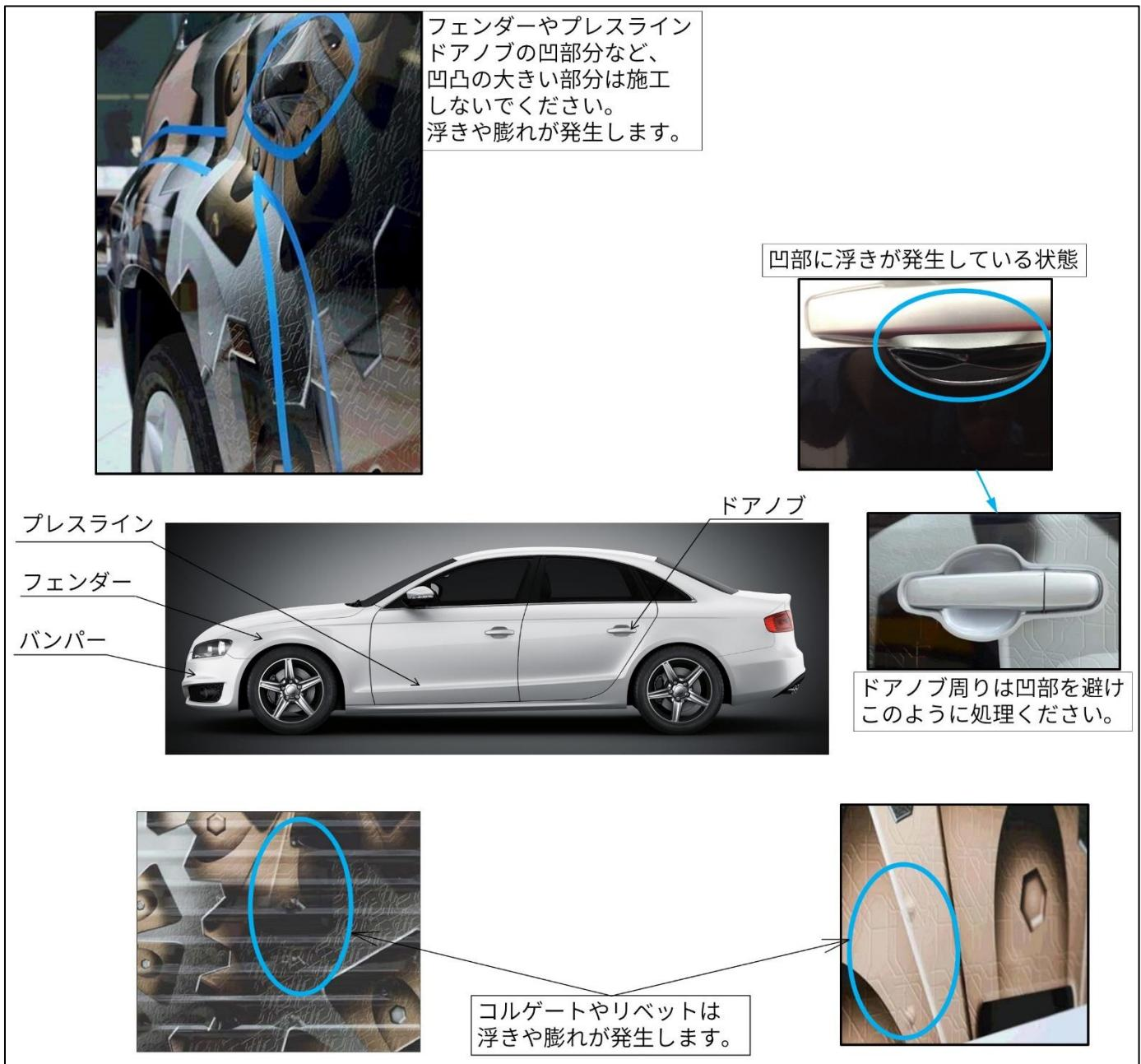
写真 1 凹凸の大きい部分の例
