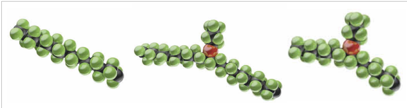
Bild 2: Molekularer Aufbau von PTFE (links), modifiziertem PTFE (Mitte) und PFA (rechts)
